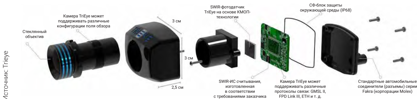
Рисунок 2. Структура SWIR-камеры корпорации Trieye
