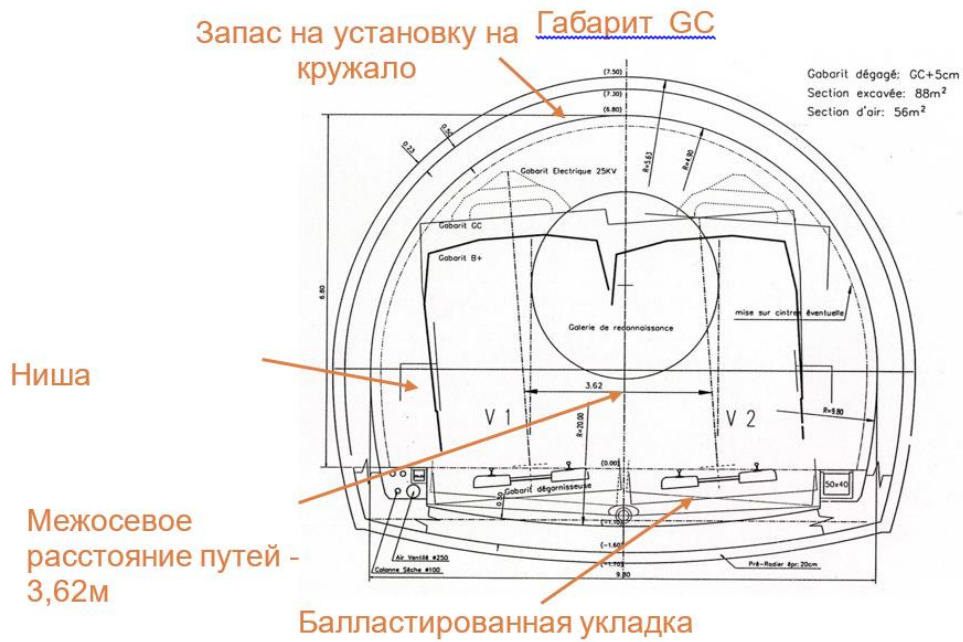
Рисунок 5.3 - Типовое сечение двухпутного (DV) тоннеля в Монако
