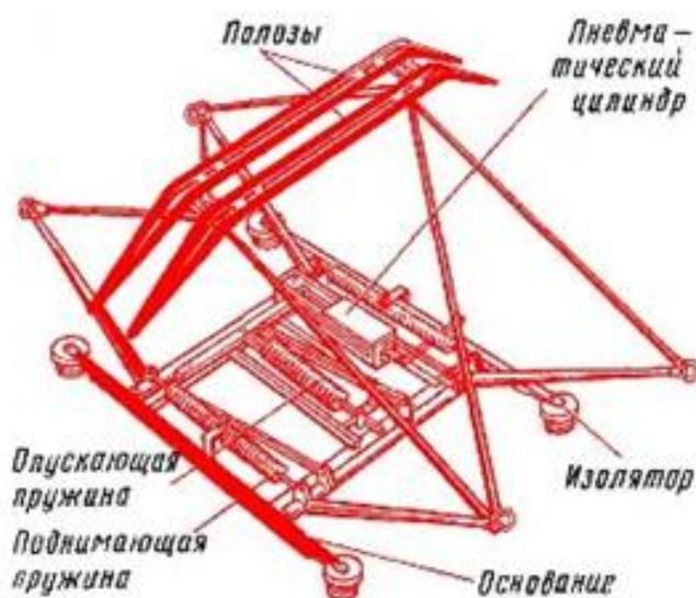
Рисунок 55. Токоприемник П-3
