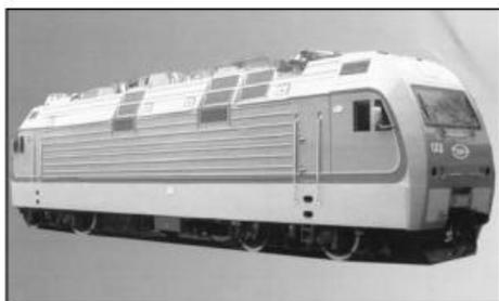
Рисунок 49. Электровоз постоянного тока 2ЭС4К
