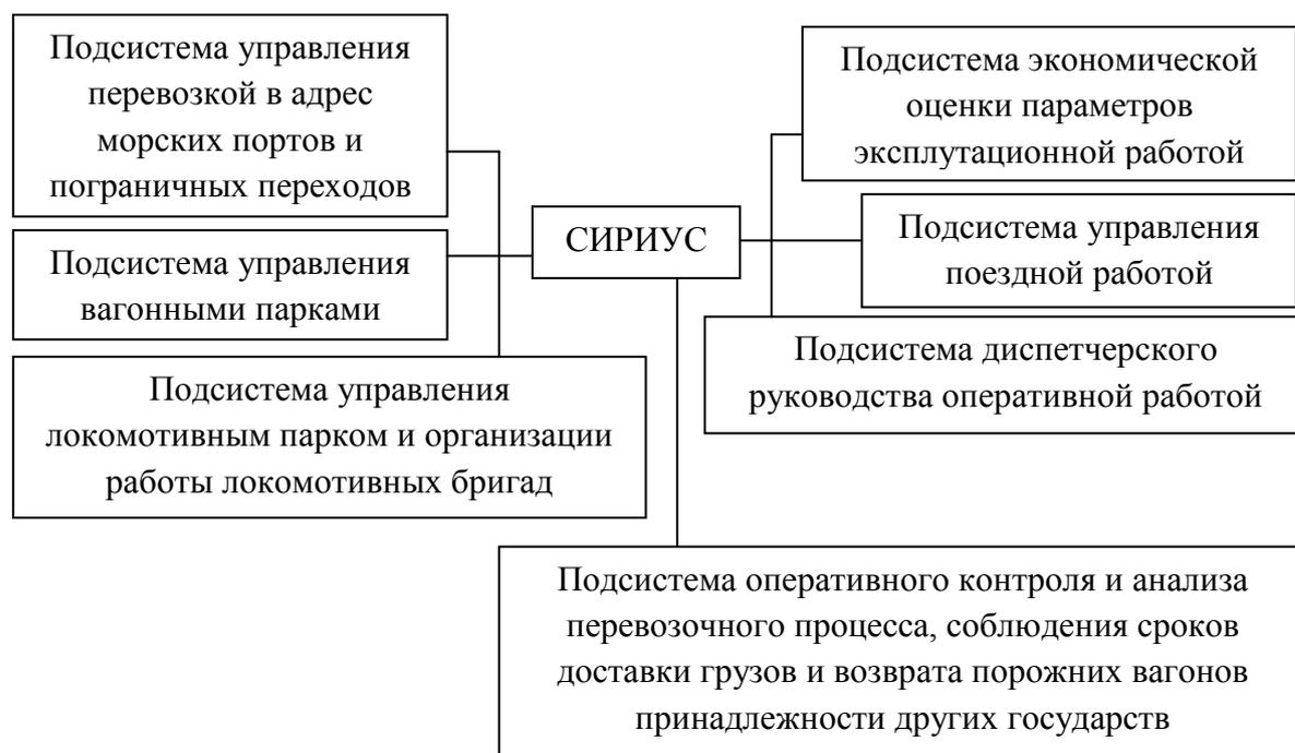
Рисунок 100. Структура информациионо-управляющей системы СИРИУС
