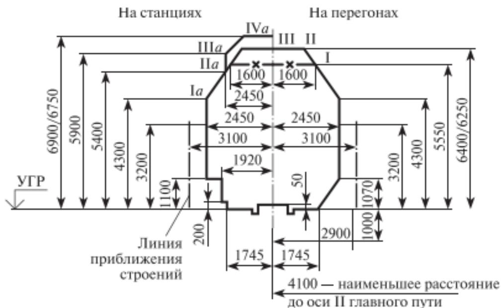
УГР — уровень верха головки рельса; х — для сооружений и устройств на путях, где электрификация исключена
