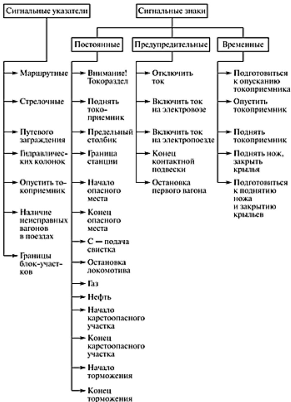
Рисунок 79. Классификация сигнальных указателей и сигнальных знаков
