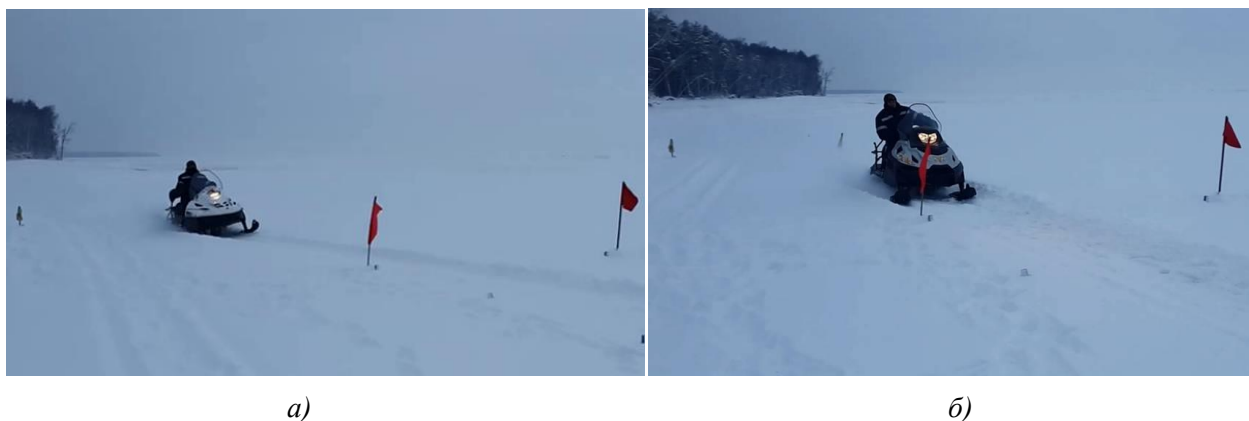
Рис. 10. Фрагмент проведения испытаний снегоходов при выполнении маневра «Переставка»:
