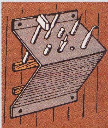
Толстый металлический лист и две деревянные планки потребуются для изготовления этой подставки для инструмента. Из листа вырежьте полоску заданной ширины и просверлите в ней крепежные отверстия и отверстия под ручки различных инструментов (молотков, напильников, паяльника).
